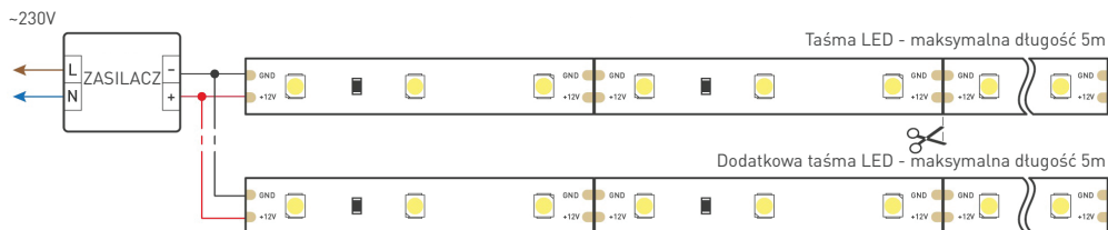
Schemat 1. Podłączenie kilku taśm LED z zasilaniem z jednej strony.
