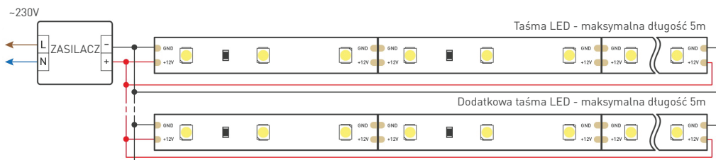
Schemat 2. Podłączenie kilku taśm LED z zasilaniem z obu stron. Zalecany schemat podłączenia w celu zapewnienia równomiernego natężenia oświetlenia na całej długości taśmy LED.
