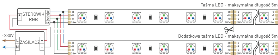
Schemat 1. Podłączenie kilku taśm LED z zasilaniem z jednej strony.
